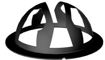
Das computergenerierte Beschattungselement des SPN1 sorgt dafür, dass immer mindestens 1 Thermoelement dem direkten Sonnenstrahl ausgesetzt und mindestens 1 vollkommen beschattet ist - unabhängig vom Sonnenstand.
