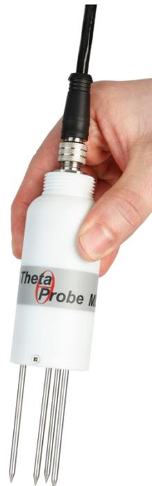
نال جهاز **ThetaProbe** شهرة في كافة أنحاء العالم لما يتميز به من الدقة والموثوقية وسهولة الاستخدام. لعمليات الرصد المستمرة (بما في ذلك قياس درجة الحرارة) يمكن لجهاز **ML3** أن يبقى مدفونًا في الأرض ومتصلًا بجهاز تسجيل بيانات مثل **Delta-T GP2** أو **GP1**.
