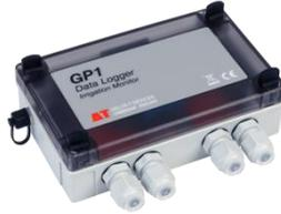
يعتبر جهاز **GP1** نموذجي لتسجيل أجهزة استشعار رطوبة التربة من النوع Delta-T: ما يصل إلى 2 جهاز من النوع ThetaProbe أو 4 أجهزة من النوع SM150T. يمكن أيضاً لجهاز GP1 تسجيل القراءات من جهاز استشعار نسبة البلل في التربة WET، وهو يتوافق مع معظم أجهزة الاستشعار البيئية التناظرية الأخرى. يوفر جهاز GP1 خيارات التحكم التناوبي المتعدد الاستخدام.
