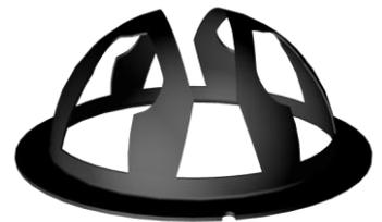
SPN1 内计算机生成的遮罩能够确保不管太阳位置如何, 7 个热电堆中有一个始终完全暴露在完整的太阳光束下, 另有一个被完全遮住。
